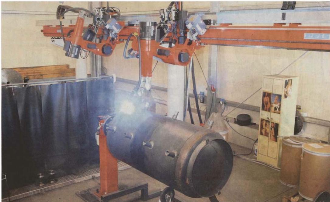
Der moderne Schweißroboter im Blech- und Technologiezentrum Linda zieht eine exakte Rundnaht an einem Pufferspeicher.
