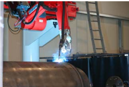
Per Roboter werden in Linda Behälter geschweißt
